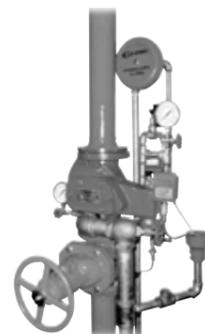
**IMPIANTO A DILUVIO** - è normalmente utilizzato sia per i sistemi a diluvio a protezione di aree come Hangars da aeroporti, sia per sistemi a protezione di aree e superfici localizzate come raffreddamento di serbatoi e lame d'acqua. E inoltre compatibile per l'utilizzo di sistemi a schiuma bassa, media ed alta espansione. Diametri gruppo di allarme da 2" - 2 1/2" - 4" - 6"
