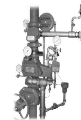
**IMPIANTO A PREAZIONE** - è studiato per applicazioni dove risulta determinante evitare un intervento accidentale dell'impianto o in sostituzione di estesi Sprinkler a secco. Diametri gruppo di allarme da 2" - 2 1/2" - 4" - 6"
