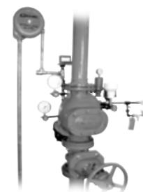
**IMPIANTO ASECCO** - l'impianto a secco è installato a tutte le aree a rischio di gelo o zone come pensiline di carico o parcheggi non riscaldati. La rottura dell'impianto Sprinkler genera una caduta di pressione che aziona l'apertura della valvola di allarme permettendo così all'acqua di raggiungere l'erogatore intervenuto ed agire sull'incendio. Diametri gruppo di allarme da 4" - 6".
