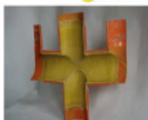
Sezioni di tubazione risanata con più innesti
