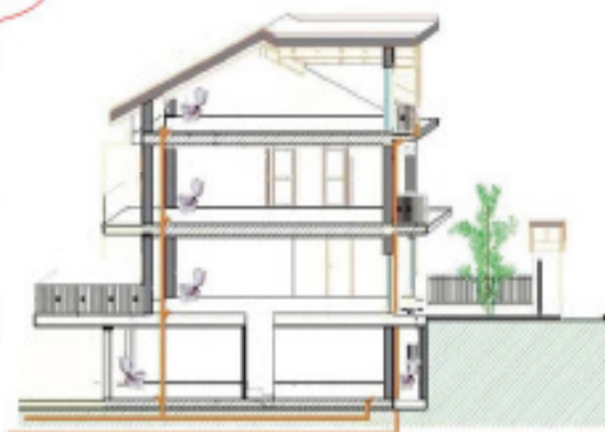
Sezioni di tubazione risanata con più innesti
